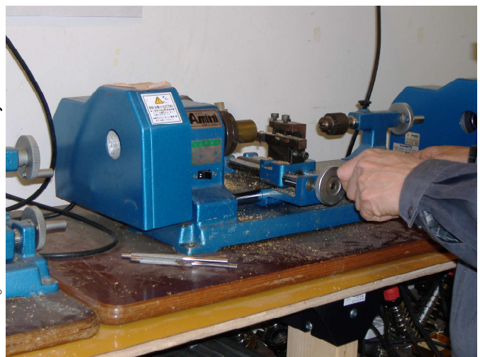
旋盤を操作しての黄銅製の丸棒の切削
