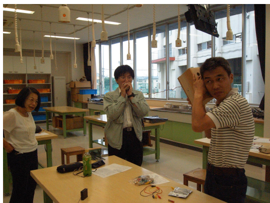
写真4 スピーカ同士を直接つないでの実験
