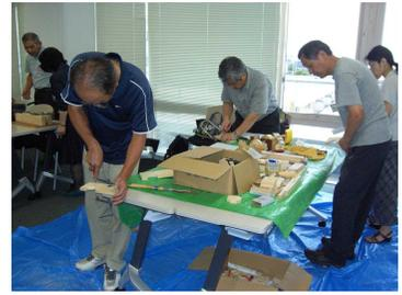
**野本勇先生(東京)**の指導で、テープカッターづくりに取り組む。材料の板材の厚さが15mm なので、材料の切断がむずかしい。部品加工の段階で寸法どおりにならなかった場合には、組立時に修正するうまい方法があるとか。接合には釘を1本も使わず、木工用接着剤ですべての部品を接合する。作品の表面をサンダー BOX(産教連通信第186号を参照)でみがいて完成。
