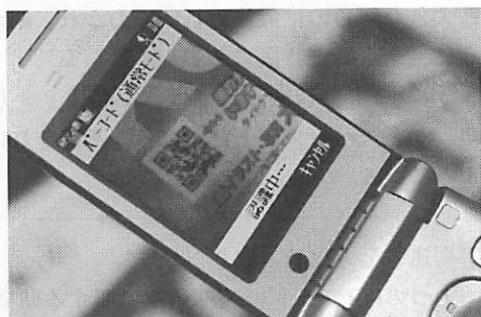
図1 QRコードを認識中の携帯電話 雑誌に印刷されたQRコードを認識しているところ
