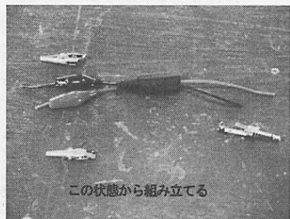
写真7 スピーカー接続コードの使用パーツ
