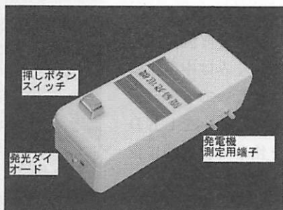
写真7 簡易発電機の外観
