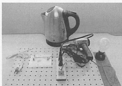
写真3 たこ足配線実験装置
