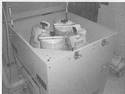
写真1 回転式バレル研磨機
