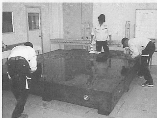
写真1 石定盤を磨く作業
