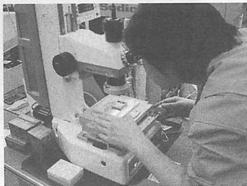
写真2 金属部品に超硬を重ねた部分を調べているところ
