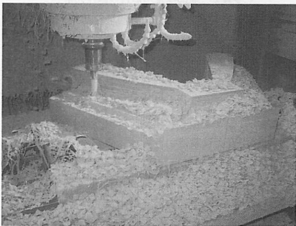
写真3 マシニングセンタを使って形状の削り出し
