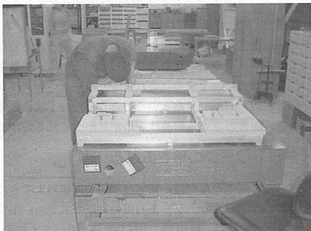
写真2 製品検査用治具の製作光景
