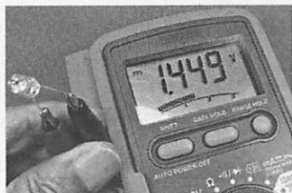
写真12 LEDの発電実験
