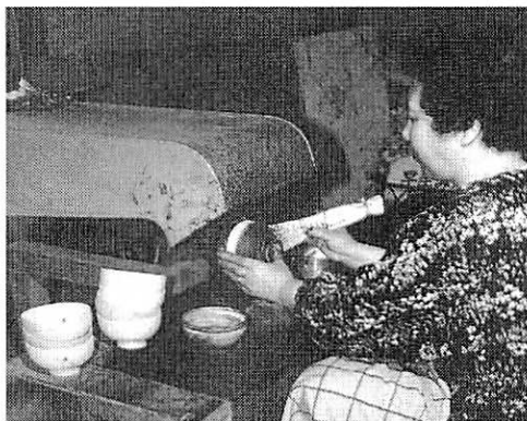
写真2 渋下地塗りの様子（秋田県漆器工業協同組合提供）
