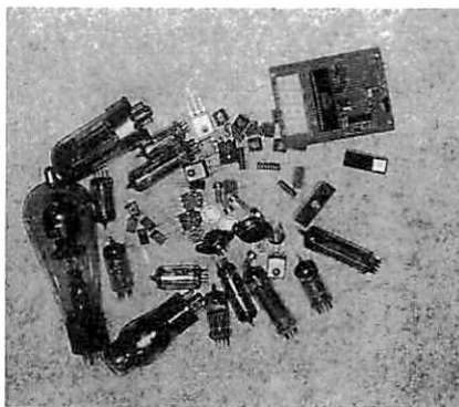
写真2 能動素子の変換 (右より)大型真空管・MT管・トランジスタ・IC・LSI
