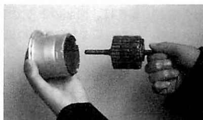
写真5 はずみ車式の内部
