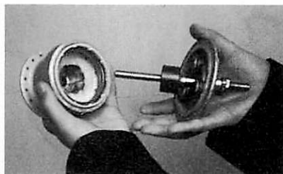
写真2 遊星摩擦車式の内部
