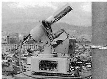
写真2 回転式日射計 (江波山気象館ホームページより転載)
