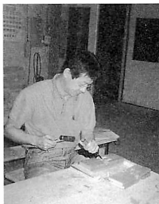
写真3 のみによる欠き取り作業
