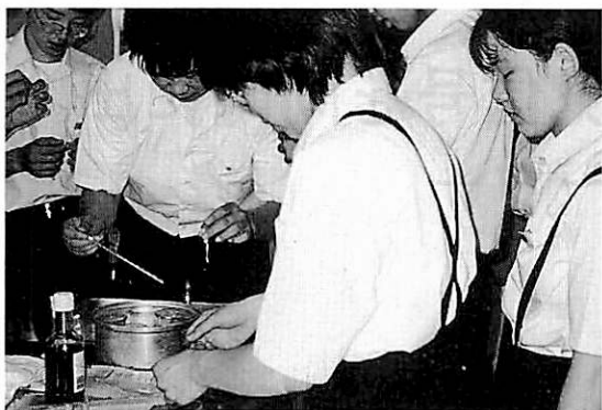
写真3 合成着色料の検出実験で毛糸を取り出している様子
