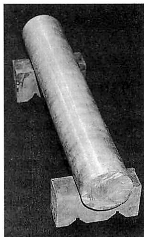
写真1 黄銅棒 (直径60mm 長さ500mm)
