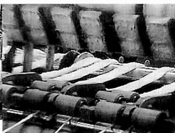
写真7 粗紡機のローラードラフト部 (カバーを開けた状態)
