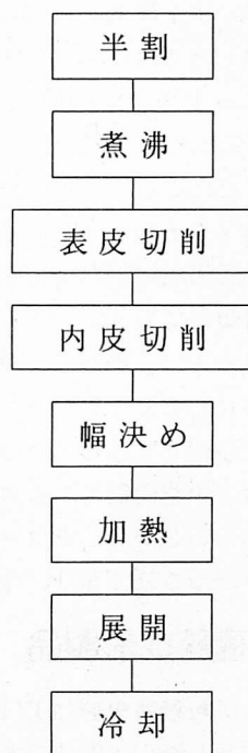
図2 竹平板製造工程図
