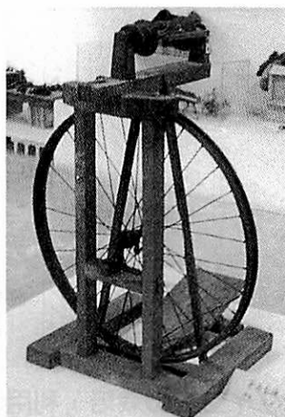
写真7・8 (右) わが国で使われた垂直式フラックスホイール
