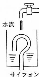
図2 定時限水洗トイレの原理
