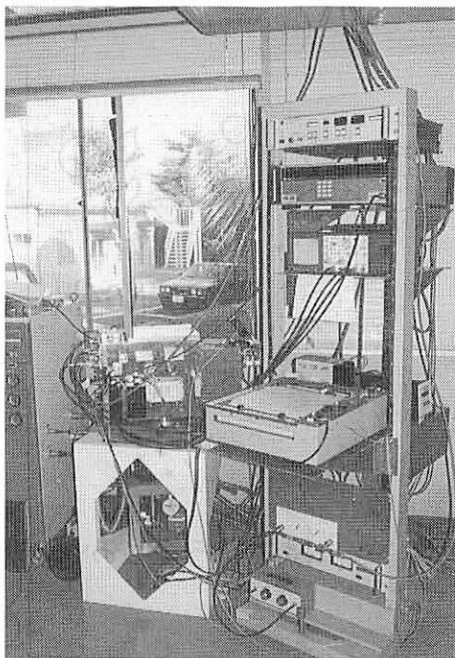
写真1 オゾン測定装置の全体
