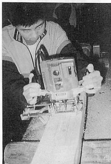
写真9 柱・ルーターで溝を彫る
