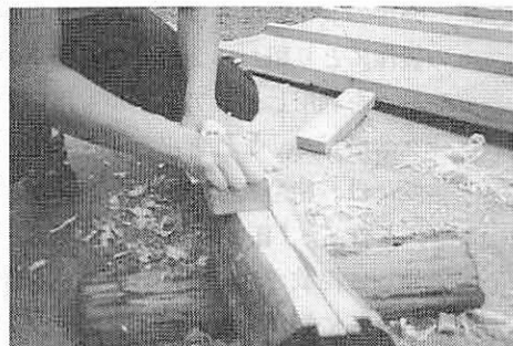
写真25 丸太の上下を平面に削る
