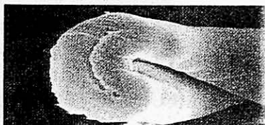
図8 綿繊維の断面と側面
