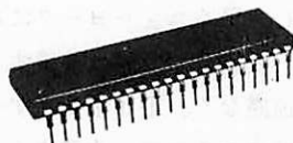
大規模集積回路(LSI)の例 トランジスタ数千から数万個のはたらきをする。
