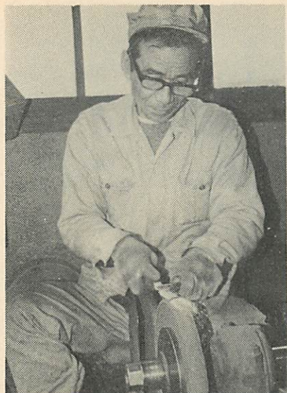
写真8 丸のみを研磨する高橋昇さん 決めた温度でぴたっと焼を入れる。しかし鉛による焼入れは微量であるが脱炭するともいわれ、炭による焼入れの方がよいとされる。ところが炭を使うと焼入れ温度の決定が難しく、長年の経験と勘に頼らなければならない。
