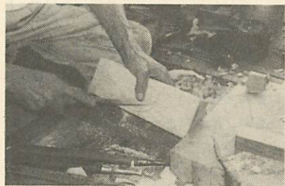
写真7 刃口をのこびきする
