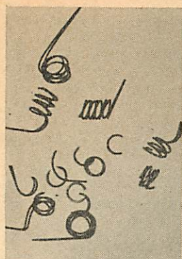
写真2 焼き入れ後に力を加えて折れたバネ
