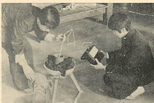
写真2 りつぽ中の温度を測定しているところ
