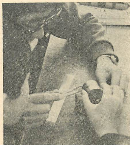
写真2 Vブロックと片パスによるけがき作業
