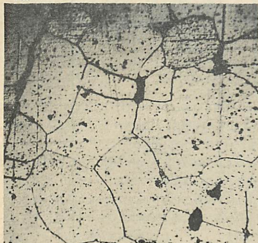
加工前の地金部素材 白い部分がフェライト 黒い部分がパーライト 軟鋼であることがわかる X 400
